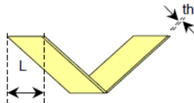
BRINELL 450 no es adecuado para la formación en caliente a una temperatura superior a  $200^\circ \text{C}$  ( $400^\circ \text{F}$ )
